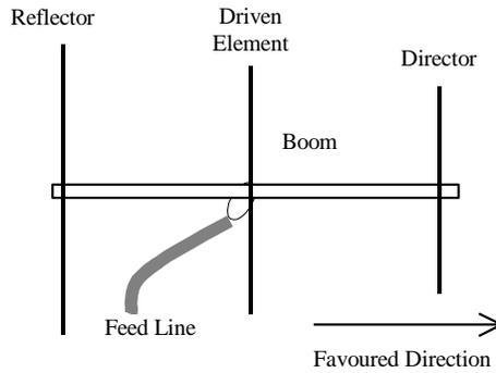
THREE-ELEMENT YAGI UDA ANTENNA
